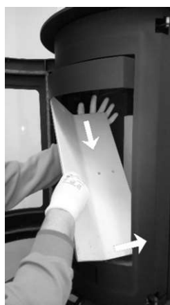
7. Tlačit kovový deflektor směrem nahoru. Betonovou boční desku uchopit za spodní hranu směrem do středu topeniště. Vytáhnout přes otvor dvířek uhlopříčně. Obě strany stejně.
